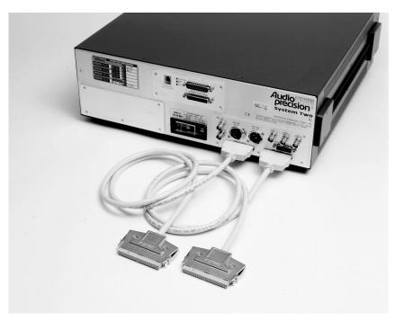
Figure 38. CAB-DIO cables.
